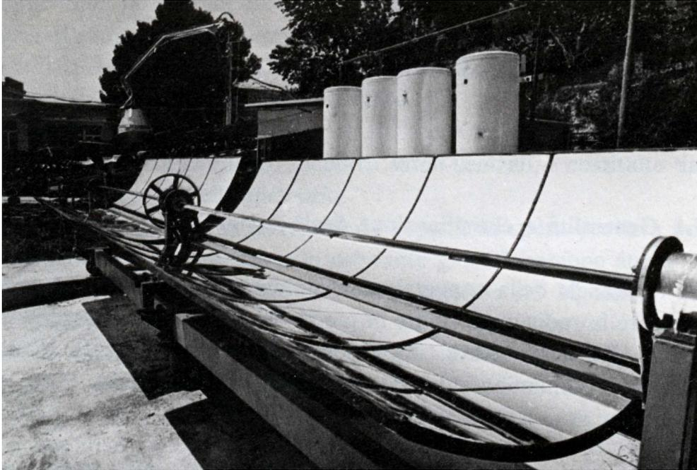
*Modulo di concentratore solare cilindrico-parabolico lineare.*
